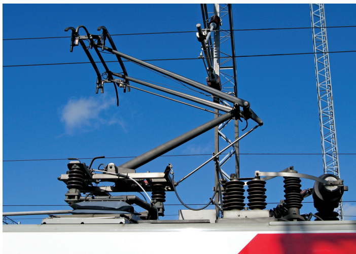
Pantograf zespołu Sm3 jest także wyposażony w mechanizm przechyłu, działający w przeciwną stronę w stosunku do przechyłu nadwozia
