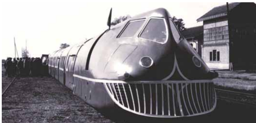
Der erste Talgo-Gliederzug lieferte schon 1942 den Nachweis der Funktionstüchtigkeit seiner geschleppten Achsen.
