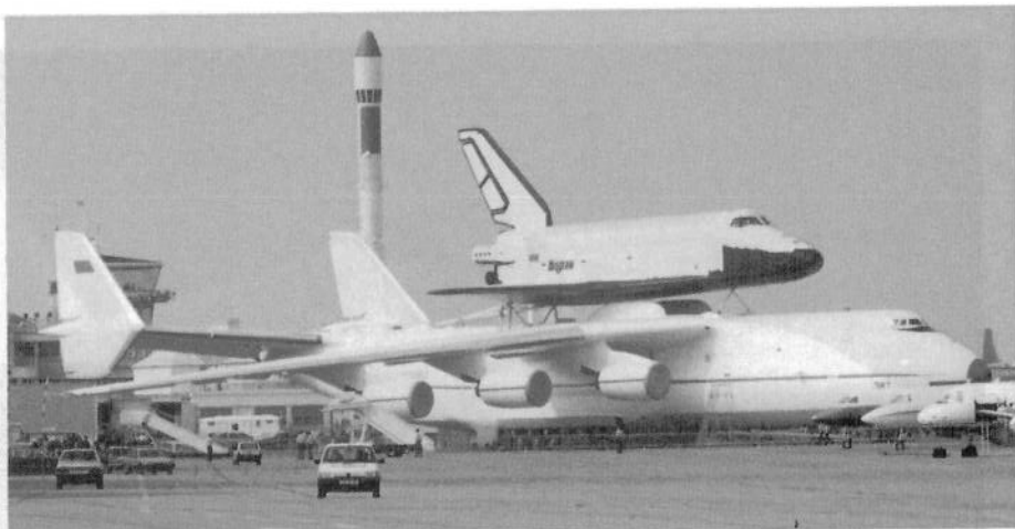
Der Schwerlasttransporter An-225, hier mit dem sowjetischen Space Shuttle Buran auf den Außenträgerpunkten fixiert, kann bis zu 600 t in die Luft heben. Angetrieben wird die An-225 von sechs Lotorev-D-18-Mantelstromtriebwerken mit je 230 kN Schubleistung. (Bild: P. Trippi)
