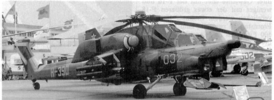
Unter der Kategorie Kampfhelikopter stellte die Sowjetunion ihr Nachfolgemodell des Mi-24 «Hind», den Mi-28 «Havoc», aus. Der zweisitzige Helikopter verfügt über eine 30-mm-Bordkanone und verschiedene Flügelaufhängepunkte für Raketen und Lenk Waffen zur Panzerbekämpfung. (Bild: P. Trippi)
