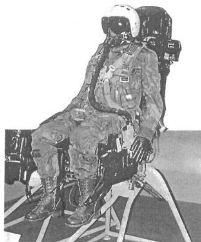
Der K-36D-Schleudersitz rettete dem Mikoyan-Testpiloten A. Kvotchur das Leben. Ein Flugzeug in vertikaler Fluglage 100 m über dem Boden bietet kaum eine Überlebenschance. (Bild: P. Trippi)
