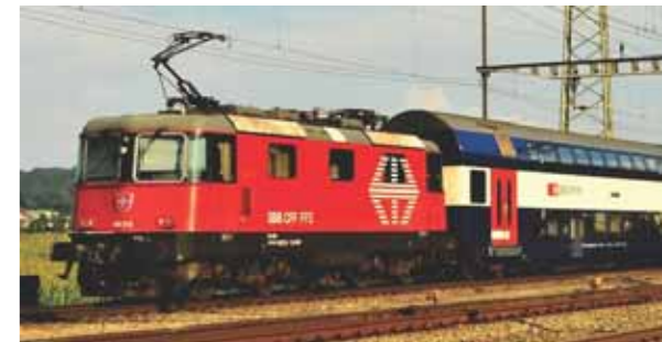
Dreizehn HVZ-Züge (Hauptverkehrszeit) mit sechs respektive zehn Doppelstockwagen im Re420-„Sandwich“ verstärken das SPNV-Netz im Berufs-Spitzenverkehr.
