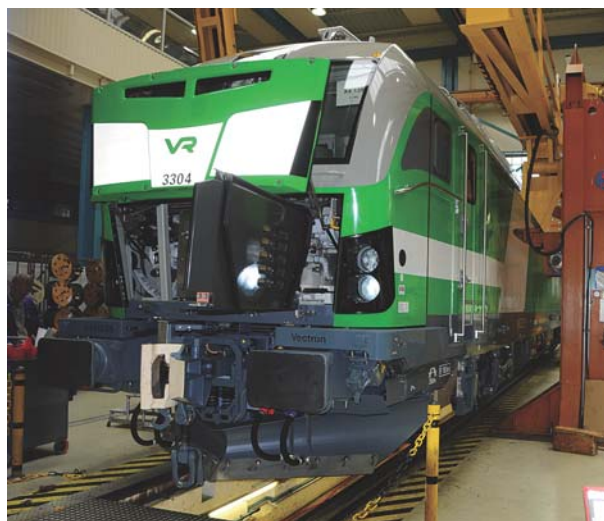
Am 2. Mai 2016 stand die VR Vectron 3304 in der Siemens Endmontagehalle in München-Allach. Die geschlossene und verstärkte Fronthaube (soll auch Elch-Zusammenstöße überstehen!) ist für Montagearbeiten angehoben. Ausgerüstet ist die Breitspur-Lokomotive mit automatischen SA3-Kupplungen wie
