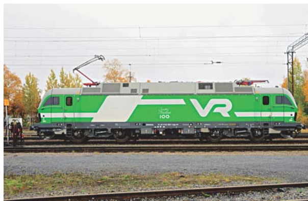
Die VR Vectron 3305, abgestellt im Güterbahnhof Seinäjoki am 6. Oktober 2017. Die finnischen Vectrons verfügen zusätzlich über eine Rangier-Funkfernsteuerung, um im Einmann-Betrieb Rangieroperationen durchzuführen.
