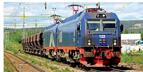
Europas stärkste sechsachsige Doppellok IORE stammt von Bombardier und wird im schwedischen Erzverkehr nach Narvik und Luleå eingesetzt.
