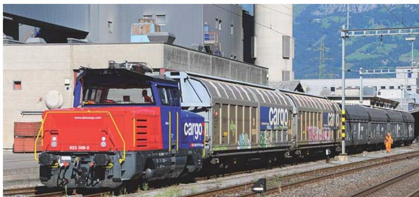
Im Dreischichtbetrieb werden die elektrisch/diesel-betriebenen Hybridloks Eem 923 die Anschlussgleise bedienen.
