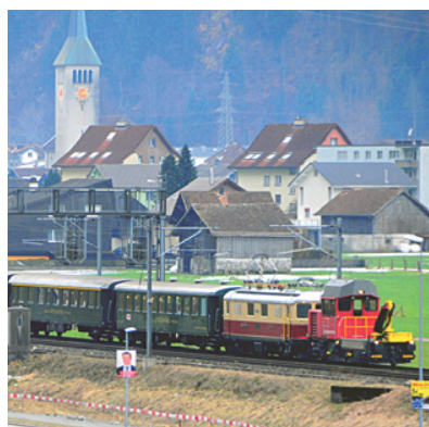
Nicht mit ETCS ausgerüstete historische Triebfahrzeuge können keine Züge aus dem Norden oder Süden auf die Gotthard-Bergstrecke führen.
