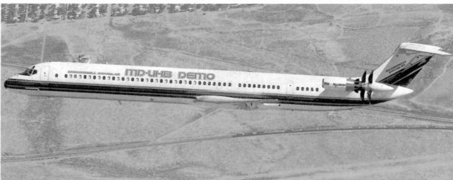
Trotz erfolgreichen Testflügen mit Propfantriebwerken (im Bild der MD-80-Prototyp mit einem am linken Rumpf installierten PW-Allison 578-DX-UHB-Triebwerk) schaffte die neue Triebwerk-Technologie den Durchbruch nicht.
