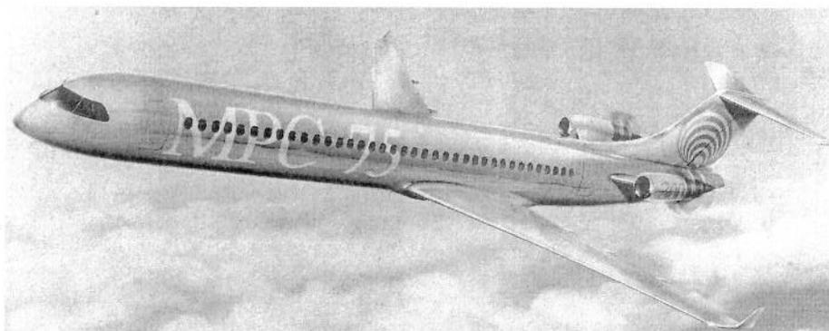
MPC-75-300 als gestreckte Version mit Propfan-Triebwerken für den Regionalluftverkehr. Ob das Projekt unter der neuen Firmenstruktur mit Mercedes, den politischen Schwierigkeiten in China und dem Fehlen eines geeigneten Propfan-Triebwerkes das Licht der Welt erblicken wird, scheint heute mehr als fraglich.
