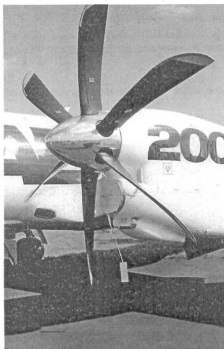
Bild 7. Hohe Leistung bei niedrigen Drehzahlen erreicht das Saab-2000-Antriebskonzept. (Bild: AVCAM/P. Trippi)
