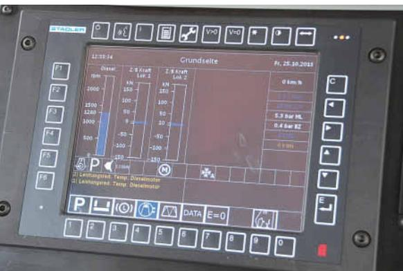
Anlässlich der Abnahme einer weiteren Eem 923 wird die Konformität der Vielfachsteuerung, hier im Dieselmotorbetrieb, mit einer anderen Eem, geprüft.
