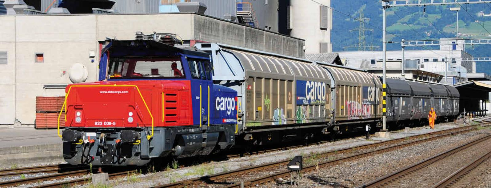
Die Hybrid-Rangierlok Eem 923 bedient Industrieanchlussgleise im Dieselmotus.
