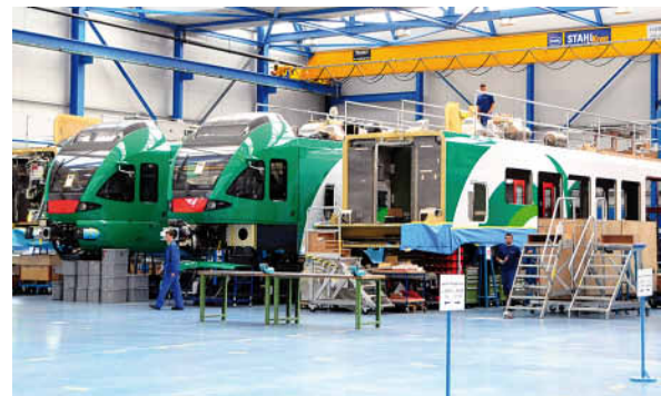
Triebköpfe für die Ferrovie Emilia Romagna in der Montage in Bussnang/CH
