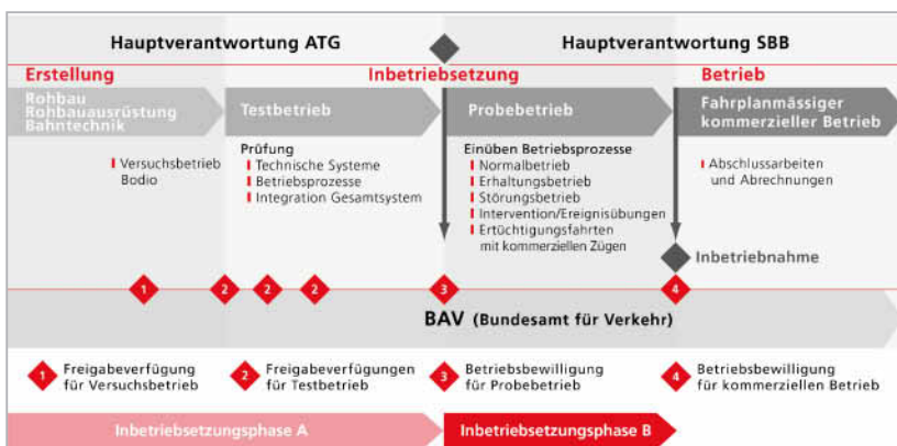
Mittels vier Projektphasen vom Rohbau bis zum kommerziellen Betrieb wird der neue Gotthard-Basistunnel schrittweise dem operativen Einsatz zugeführt.
