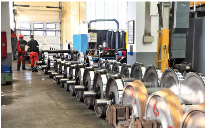
Radsätze rollen vom „Band“, einem kontinuierlichen Materialfluss durch die verschiedenen Stationen der Radsatzaufarbeitung.
