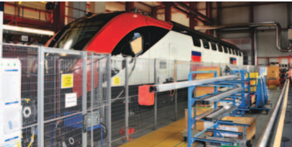
Ein Endwagen aus der Produktion in Görlitz mit VarioPantograph in der elektrischen Prüfzone im Bombardier Montagewerk in Villeneuve (Schweiz).
