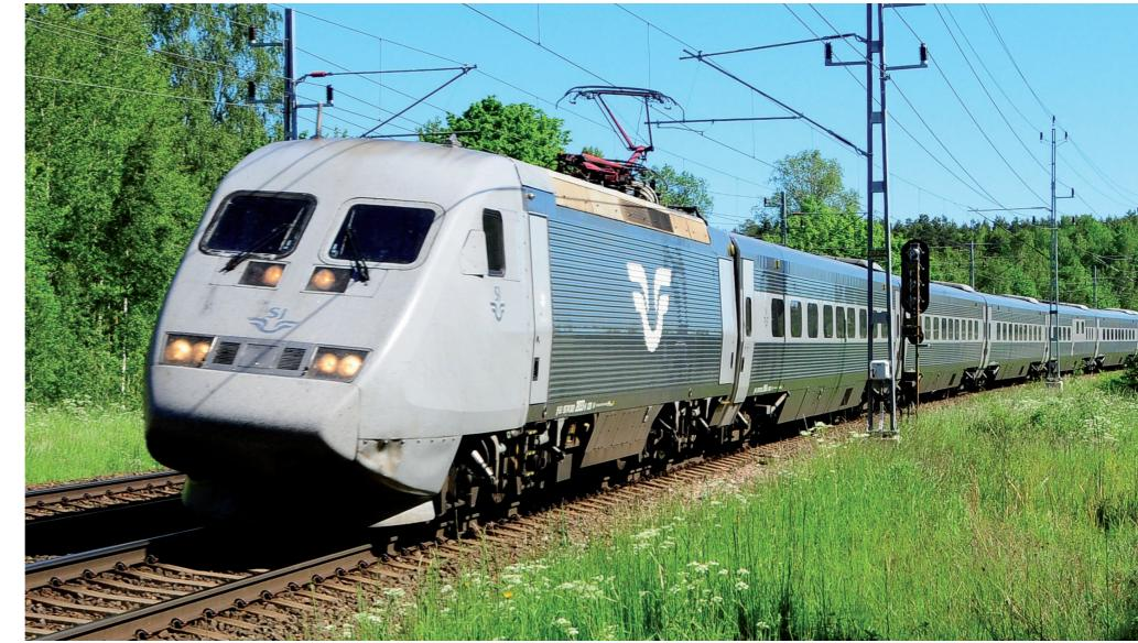
Die 36 Kompositionen X2000 bestehen aus einem Triebkopf, vier Wagen und je einem Bistro- und Steuerwagen und werden auch als Doppelheiten eingesetzt.
