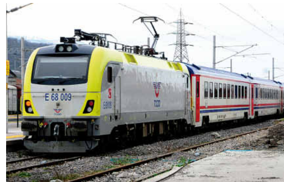
Die mit der koreanischen Firma Hyundai Rotem und der tschechischen Škoda Transportation entwickelte E68000 wird in Eskişehir durch das Lokomotiven-Werk Tülomsaş von TCDD gebaut.
