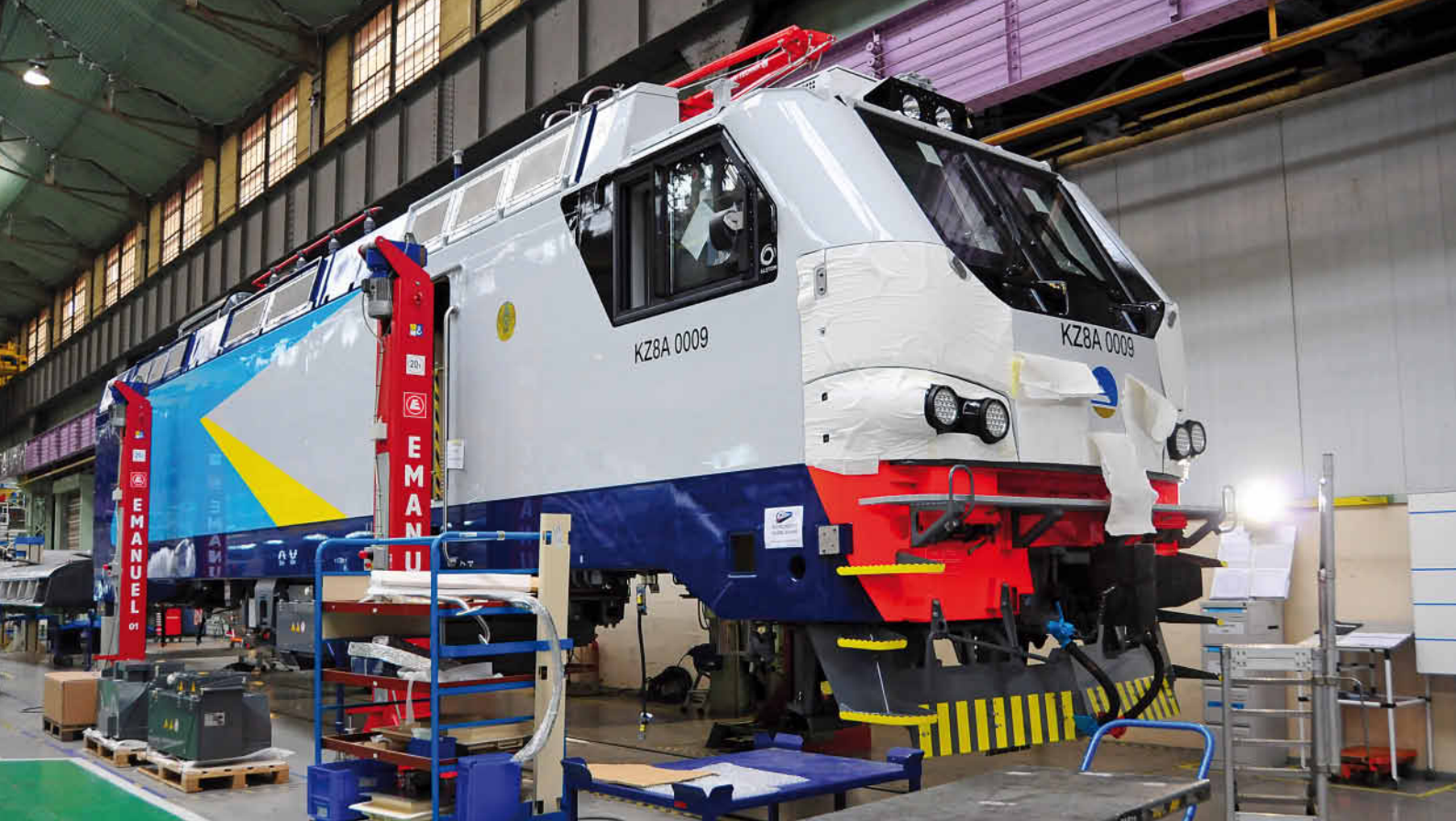
Montage der achtsichtigen Doppel-Lokomotive KZ8A 0009 für Kazachstan Temir Zholy im Alstom-Werk in Belfort.
