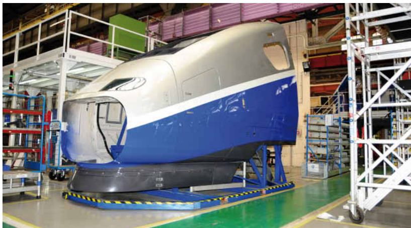
Frontsektion für einen TGV 2N2 an der Montagelinie im Alstom-Werk Belfort.
