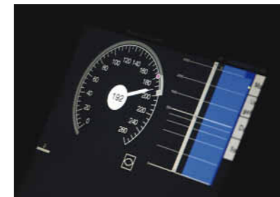
Die ETCS-Fahrerlaubnis, als blauer Balken, zeigt uns ungehinderte Fahrt mit knapp 200 km/h im Tunnel an.
