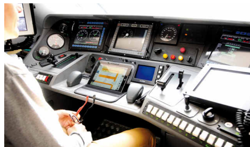
Neuerdings sind die ETR 610-Lokführer mit iPads für die Streckenanweisungen ausgerüstet. Geschwindigkeitsveränderungen erfolgen allesamt über den Tempomaten.
