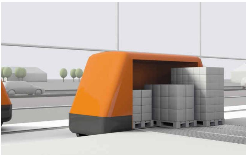
Cargo-U-Bahn: Die Güter sollen von Hub zu Hub 24 Stunden vollautomatisch mit einer Geschwindigkeit von rund 30 km/h transportiert werden.
