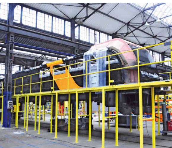
Mit der sechsachsigen E6 Dragon wird 2013 erstmals seit 25 Jahren in Polen wieder die Serienfertigung einer Lokomotive aufgenommen. Newag Gliwice S.A. baut zurzeit die Taktstationen hierfür auf.
